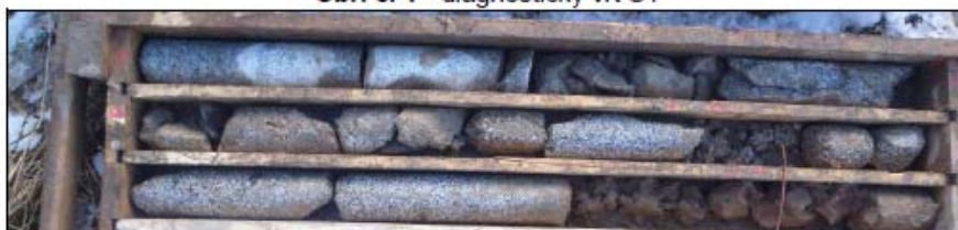
Obr. č. 2 - diagnostický vrt V1
